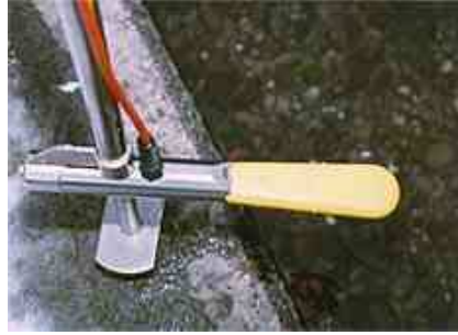
FIG. 3.12 – Photo du courantomètre électromagnétique utilisé pour les jaugeages
