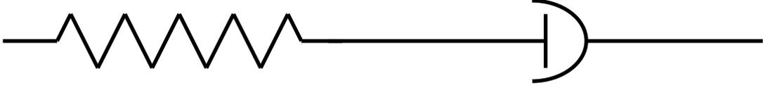
Figure II.4.1 : Représentation de l'élément de Maxwell
