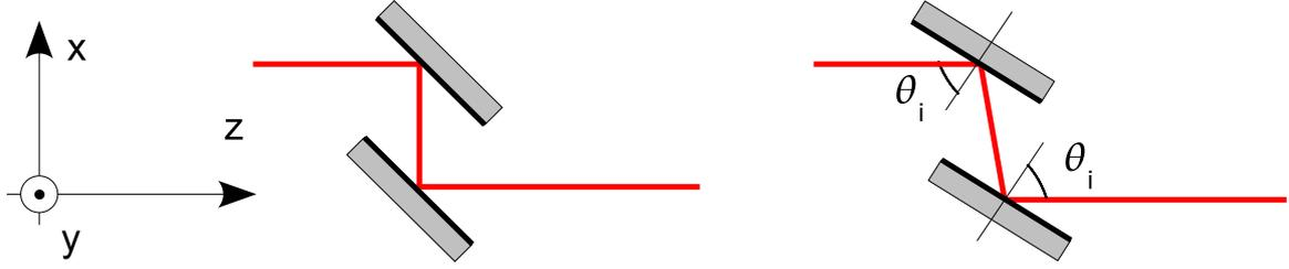
FIG. 3.10: A gauche, schéma d'un bras d'interféromètre utilisé pour illustrer l'effet du déphasage différentiel. A droite convention angulaire utilisée pour le calcul
