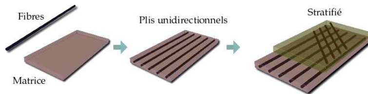
Figure 5.1 – Constitution du composite stratifié à fibres longues
