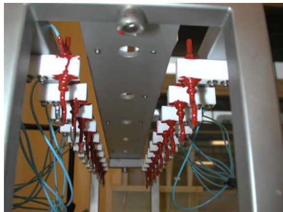
b- Contact électrique échantillon-crochet-cosse-fil protégé par un vernis isolant
