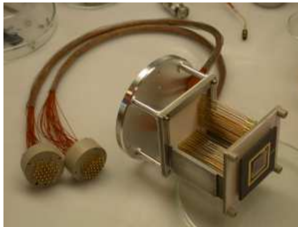
FIG. 3.17: Ensemble de porte-échantillon utilisant une connectique mixte.
