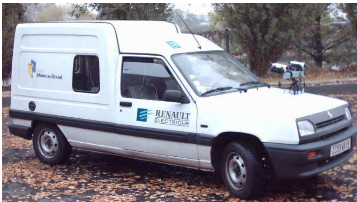
Figure.III.51 : Le véhicule électrique expérimental de l'école des mines de douai, équipé d'une tête stéréo montée sur son capot et d'une unité de traitement embarquée.
