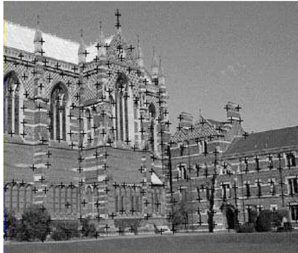
Figure III.5 : Résultat de la procédure de détection des coins (image de Marc Pollefeys).
