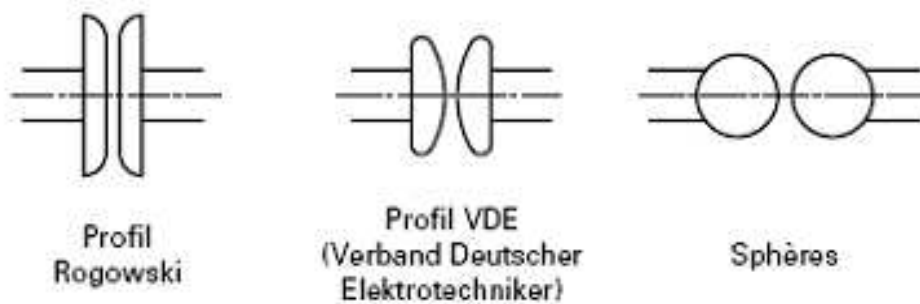
Figure I.20 : Configurations d'électrodes utilisées pour l'étude du claquage en champs uniformes ou quasi uniformes [33]
