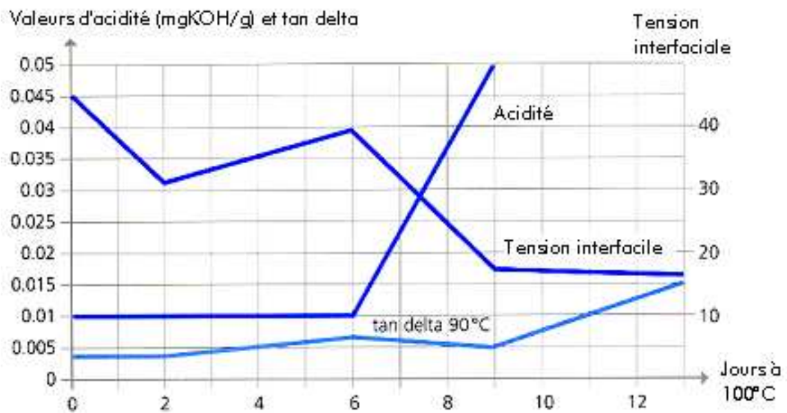
Figure I.51 : Evolution de différentes caractéristiques en fonction du temps de vieillissement (bêcher ouvert à 100°C) sur une huile minérale non inhibée [4]
