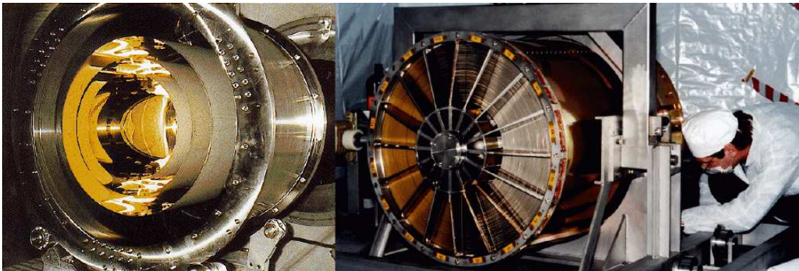
FIG. 4.2: Vues d'un module de miroirs. Gauche : en cours d'intégration avec seulement trois coquilles (ESA, web). Droite : en fin de montage, avec les cinquante-huit coquilles maintenue par l'araignée faciale (ESA, web).
