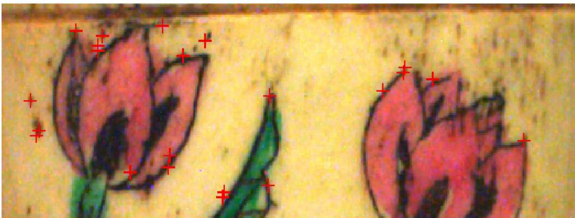
Figure 4.8 - Points d'intérêt détectés par le détecteur de Harris Précis Couleur sur une partie de l'image Ivoire2.
