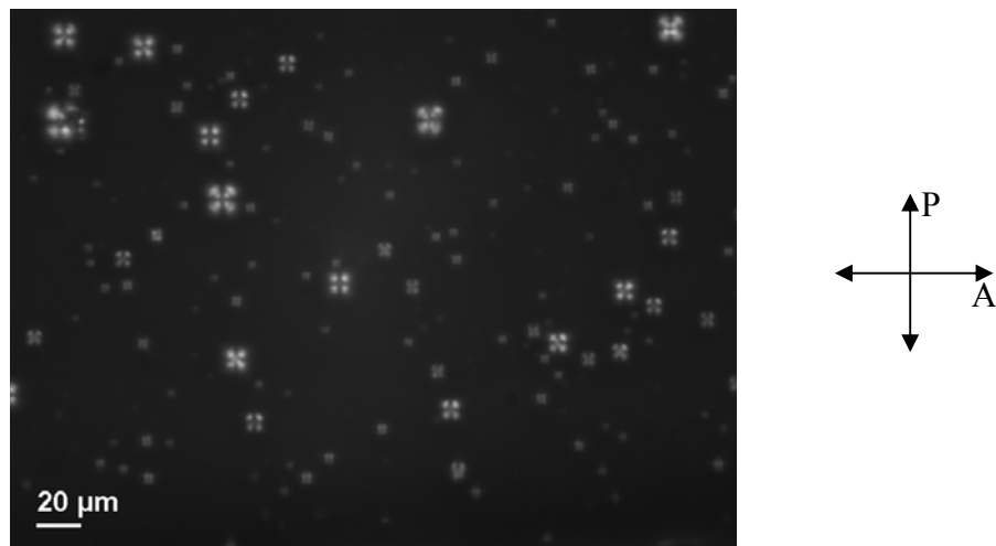
Figure 21 : Observation en microscopie optique, en condition de polariseurs croisés, de l'émulsion 5CB dans l'eau avec l'utilisation du surfactant C12G.
