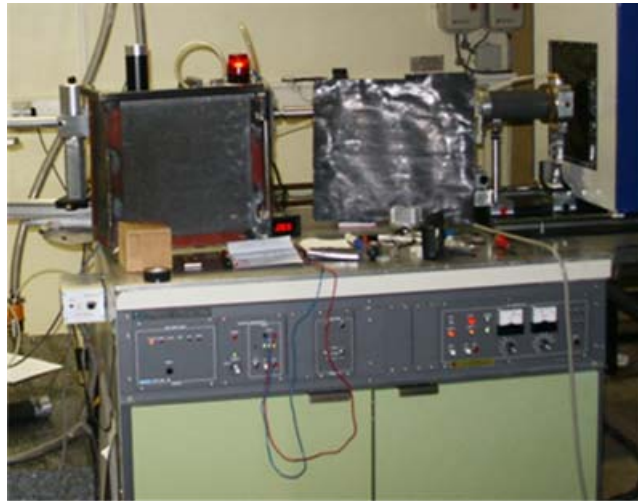
Figure 11 : Dispositif expérimental de la diffusion de rayon X aux petits angles du L.C.V.N.
