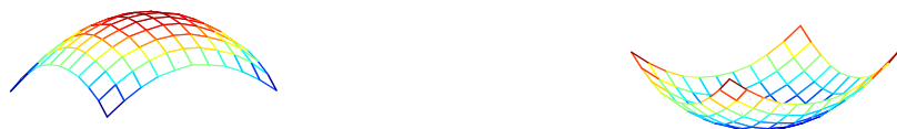
Figure II- 6 . Représentation schématique d'un film déposé en compression (schéma de gauche) ou en tension (schéma de droite) sur un substrat sous-jacent.
