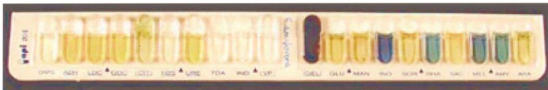
Exemple d'une galerie du système API 20E avant l'addition des réactifs
