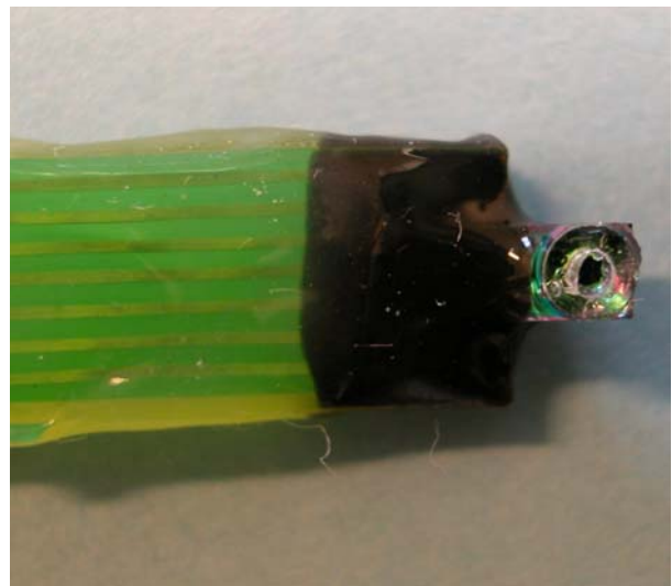
Fig. II - 20 : Micro cuve en PDMS reportée sur un ISFET
