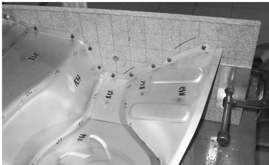
FIG. 8.4 – Réalisation de l'encastrement
