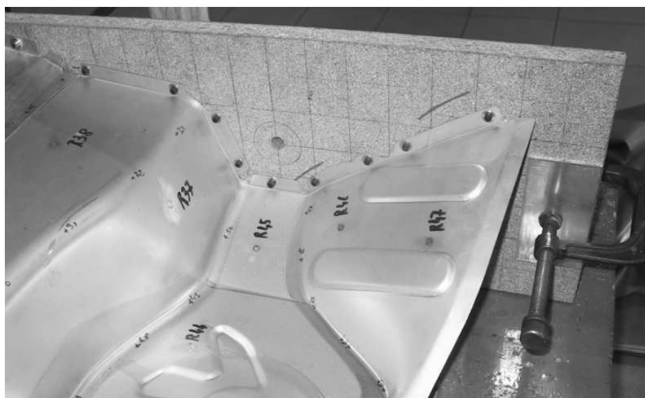
FIG. 8.4 – Réalisation de l'encastrement
