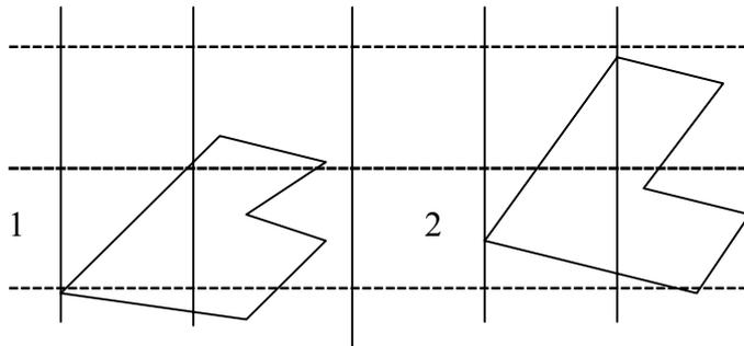
**Fig. 37 : Erreurs générées dans le positionnement des points amers sur deux photographies successives**
