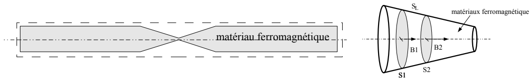
FIG. 5.7 – Application de la conservation du flux de \mathbf{b} à travers un tube de flux qui s'appuie sur les bords d'un cylindre aminci dans sa partie centrale.
