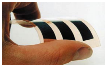
Figure 2 : Cellule photovoltaïque souple (polymère) développée à l'université de Linz (Autriche) [15].
