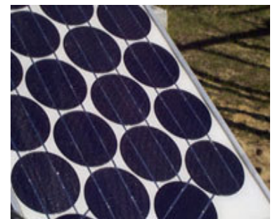
Figure 4-7 : Panneau PV constitué par M cellules séries et N colonnes de cellules parallèles A) structure d’un panneau PV, B) panneau solaire en silicium monocrystallin [144].
