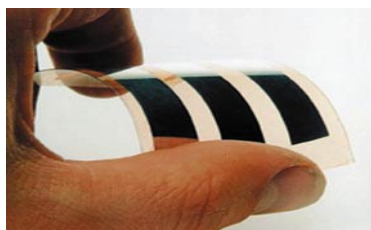
Figure 2 : Cellule photovoltaïque souple (polymère) développée à l'université de Linz (Autriche) [15].
