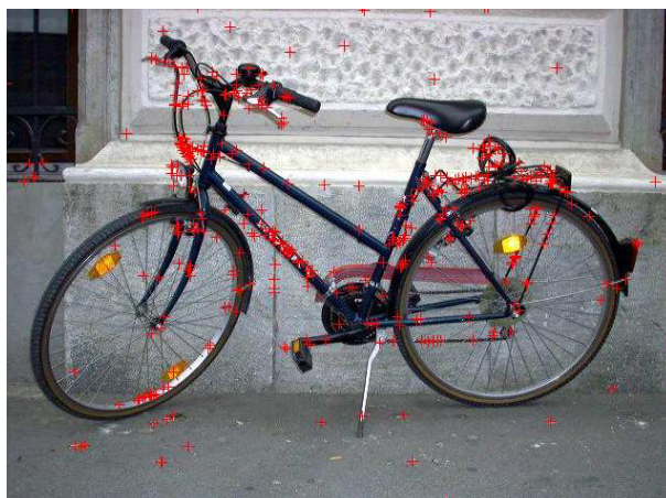
FIG. 1.4 – Les 100 points les plus forts en énergie de Laplacien détectés par le détecteur Harris-Laplacien.
