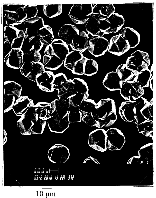
Fig.2- 7 : Dépôt de diamant obtenu sur un substrat de molybdène précarburé ( \text{Mo}_2\text{C} ).
