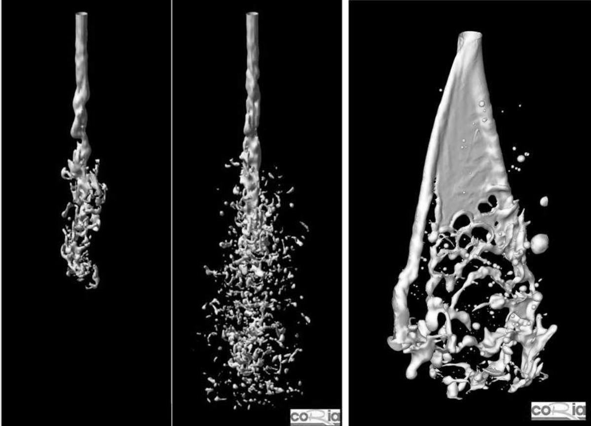
FIG. 24 – Deux simulations réalisées par A.Berlemont et S.Tanguy de la rupture d'un jet liquide à l'aide des méthodes Level-Set et Ghost-Fluid; (à gauche) un jet très rapide turbulent de diesel avec \rho_l = 696 \text{ kg.m}^{-3} , \rho_g = 25 \text{ kg.m}^{-3} , V_l = 100 \text{ m.s}^{-1} , V_g = 0 \text{ m.s}^{-1} , u'/U = 0.05 et un maillage 64 \times 64 \times 256 ; (à droite) un jet d'eau swirlé avec \rho_l = 1000 \text{ kg.m}^{-3} , \rho_g = 1.3 \text{ kg.m}^{-3} , V_{max} = 19 \text{ m.s}^{-1} et un maillage 64 \times 64 \times 256 .
