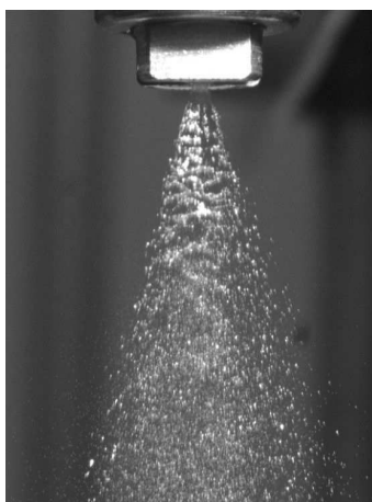
FIG. 3 – Un injecteur pression classique. Génération d'un spray de gouttelettes.
