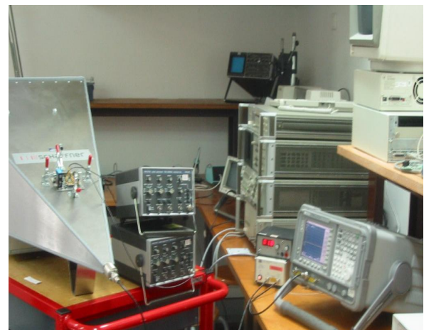
Figure III-59. Banc de test : cellule GTEM et carte Cesame
