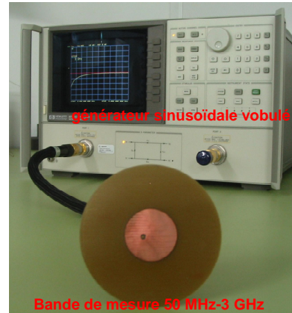
Figure III-3. l'antenne patch réalisée
