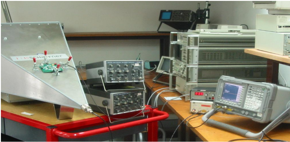
Figure III-51. Banc de test cellule GTEM carte Atmel 2_Atmeag128/169
