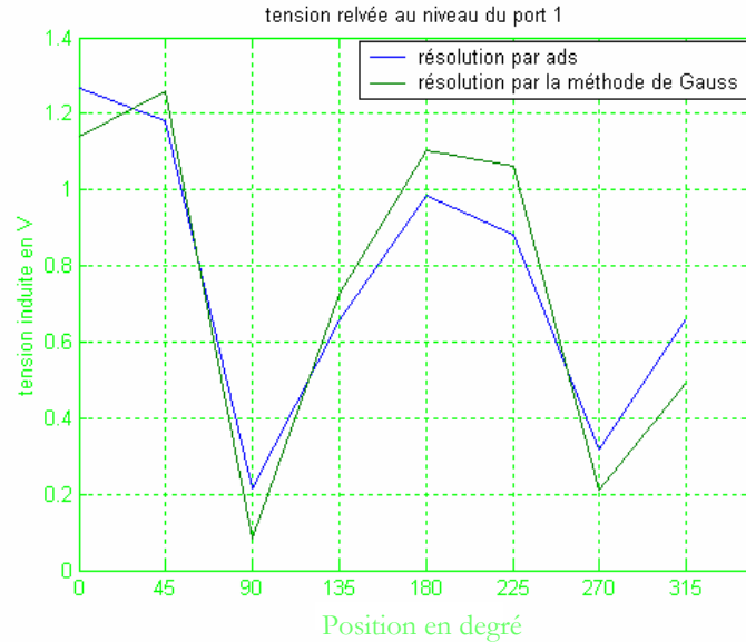
Figure IV-47. Comparaison entre les deux méthodes pour ( P1=0, P2=0, P3=1 )
