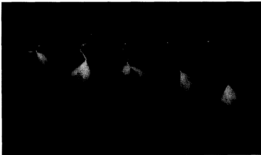
Figure I-2a : développement d'une décharge positive enregistrée en mode image par image (frame) à l'aide d'un convertisseur d'image [16].
