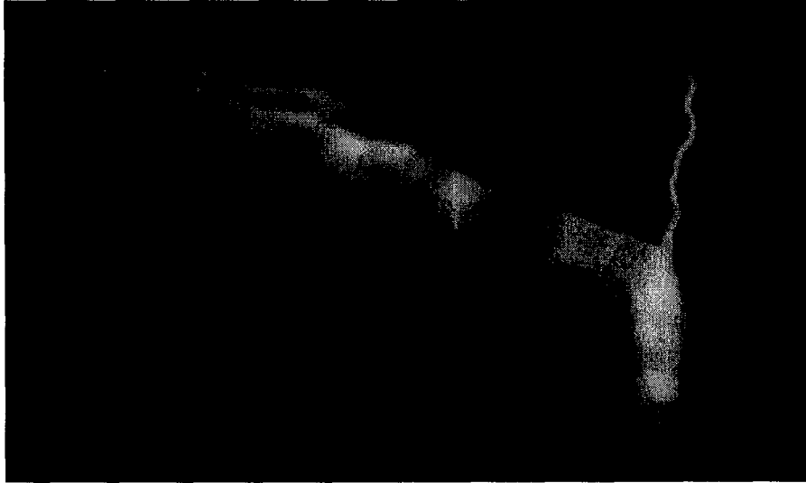
Figure I-2b : développement d'une décharge positive enregistrée en mode balayage (streak) à l'aide d'un convertisseur d'image [16].
