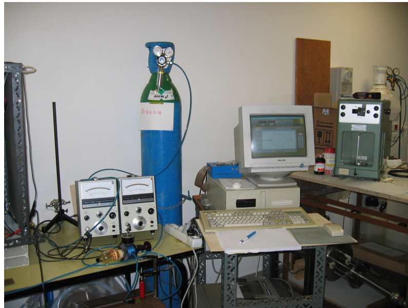
FIG. 4.4 – Photographie du dispositif de mesure ECT, pico-ampèremètres Keithley, bouteille d'argon et ordinateur permettant l'enregistrement des courants.
