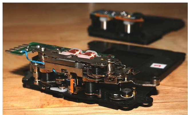
Illustration 3.4.6: Un obturateur et son complexe mécanisme de mise en mouvement des lamelles.
