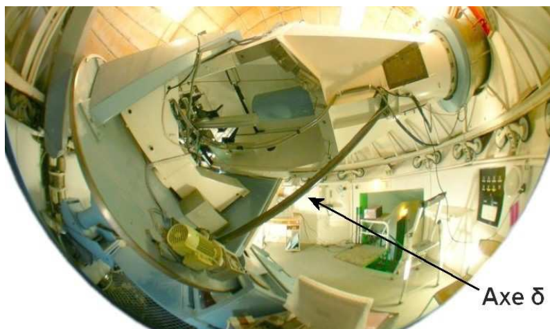
Illustration 2.5.1: La LJR et son axe de déclinaison reliant la table équatoriale (en bas) et le milieu du tube (en haut).
