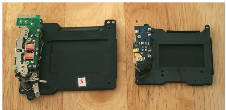
Illustration 3.4.7: Deux types d'obturateurs à lamelles: format standard 24x36mm à gauche et APS 17x30mm à droite.
