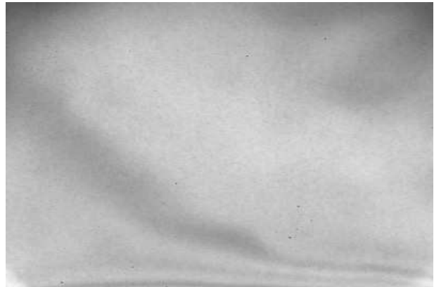
Illustration 4.1.10: Franges d'interférences sur le capteur visibles avec un filtre de 10nm de bande passante placé devant l'optique.
