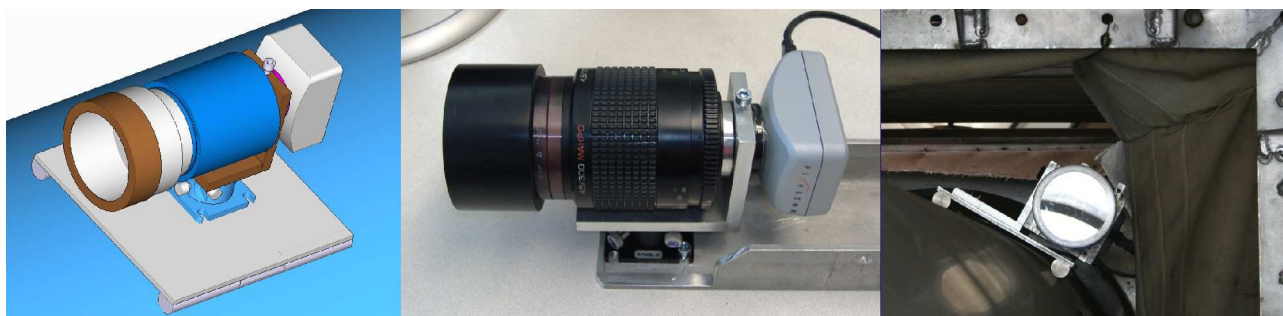
Illustration 2.5.4: De gauche à droite: modèle 3D de la caméra de pointage, assemblage réalisé et caméra montée sur le tube de la LJR.
