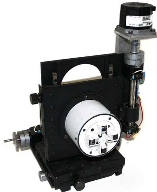
Illustration 2.4.3: La lunette-guide et sa nouvelle tête optique.
