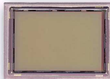
Illustration 6.2.1: Le capteur CMOS IBIS4-14000 dans son boîtier. Surface sensible: 24 x 36 mm.
