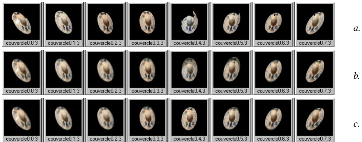
Figure 2.4 – Quelques points de vue (l'indice u varie de 0 à 7, de gauche à droite) pour un slab du lumigraphe. La construction du lumigraphe utilise, pour générer chaque échantillon du plan st , a. au maximum une photographie ; b. au maximum quatre photographies ; c. au maximum quatre photographies dont la focale a été estimée entre 90mm et 120mm.
