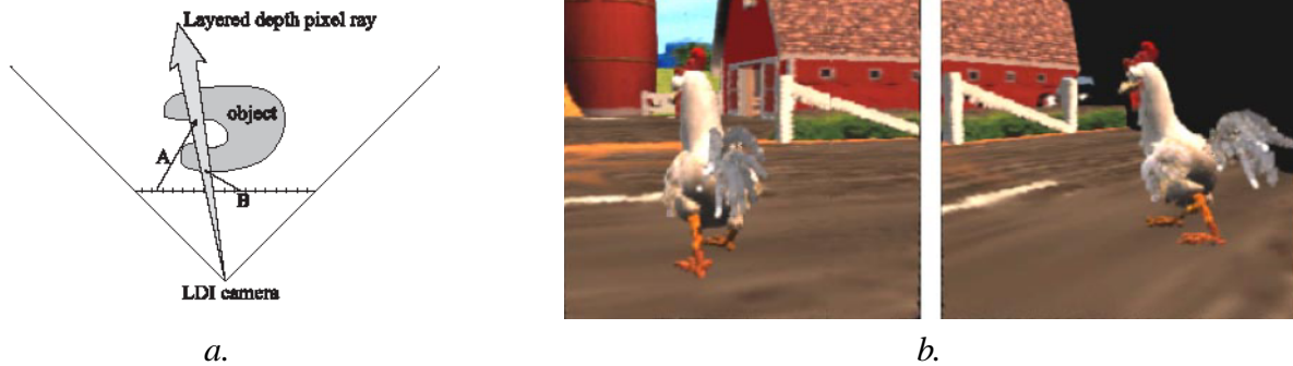
Figure 2.8 – a. Le pixel traversé par la flèche partant de la caméra dispose de la couleur des points de la surface traversés par cette flèche, à savoir la couleur des points A et B ; b. Rendu d'une poule stockée dans une carte de profondeur multi-couches pour deux points de vues différents (images extraites de [SGHS98]).
