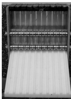
(a) Mécanisme de création de la cavité.
