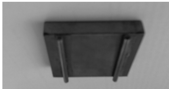
FIG. 4.4 – Détail d'un bloc de métal pesant 3,6 N utilisé pour le chargement de la structure (vue de dessous)
