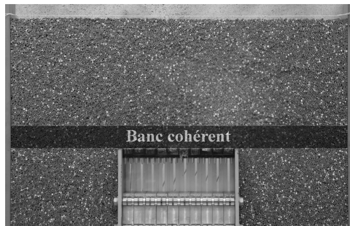
FIG. 3.16 – Configuration initiale du massif de sol avec un recouvrement de 300 mm
