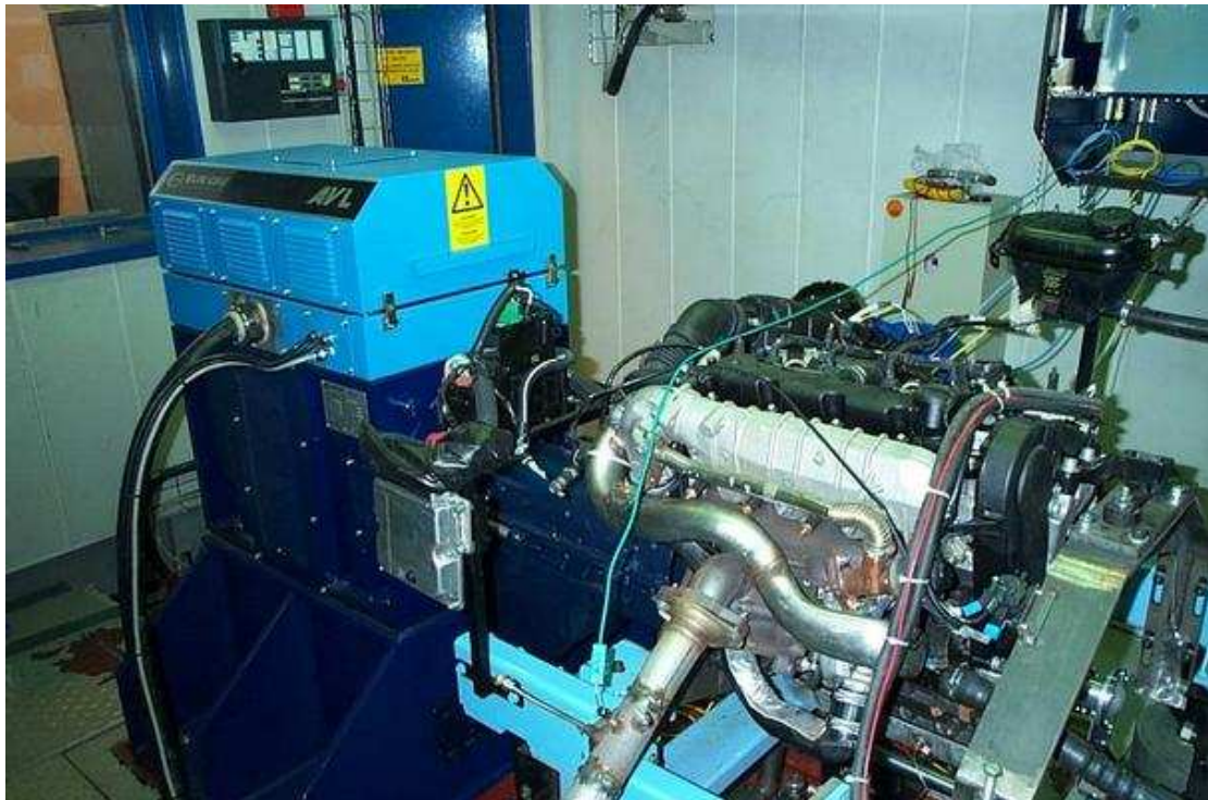
FIG. 13.2: Banc moteur dynamique du LTE. Configuration véhicule conventionnel 306 HDI (moteur DW10TD).
