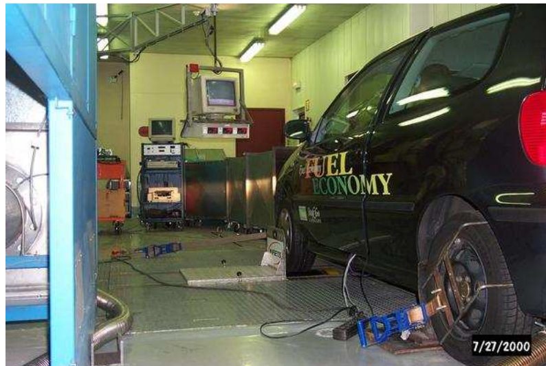
FIG. 13.1: Véhicule Volkswagen/Valeo « Stop and Go » fixé sur le banc à rouleau du LTE pour mesures de consommations
