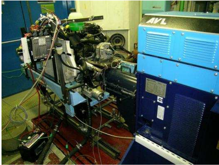
FIG. 13.3: Banc moteur dynamique du LTE. Configuration véhicule hybride deux embrayages avec moteur thermique Renault 1.5 l dCi, moteur électrique Valeo Mars, et embrayage commandé Valeo
