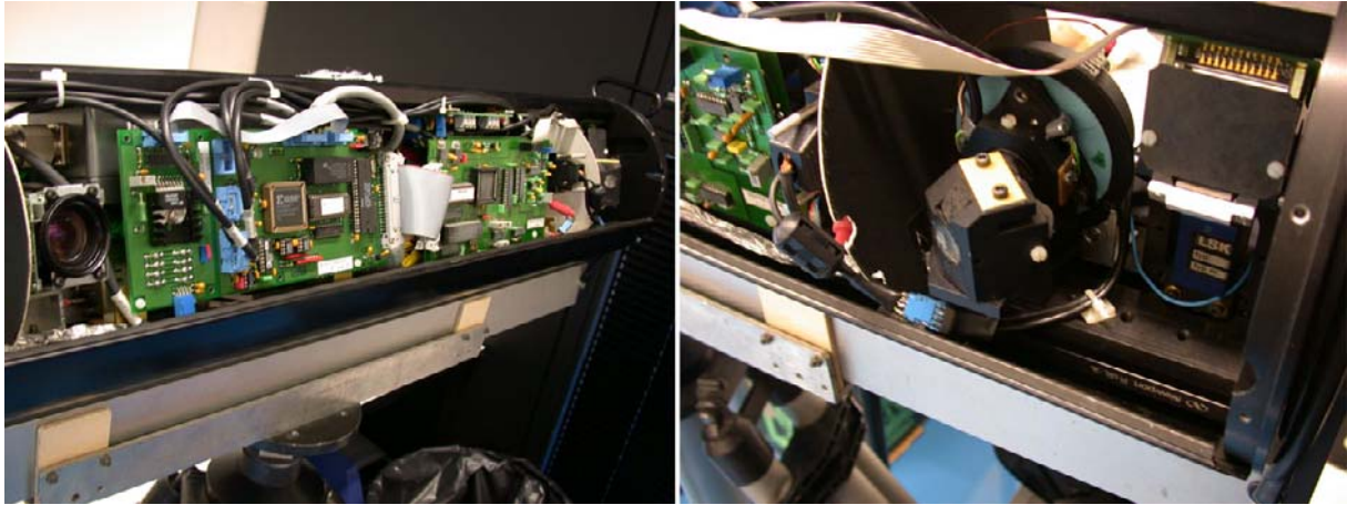
Figure 2-10 : Détail du scanner SOISIC, à gauche l'équerre optique et l'autofocus du laser.
