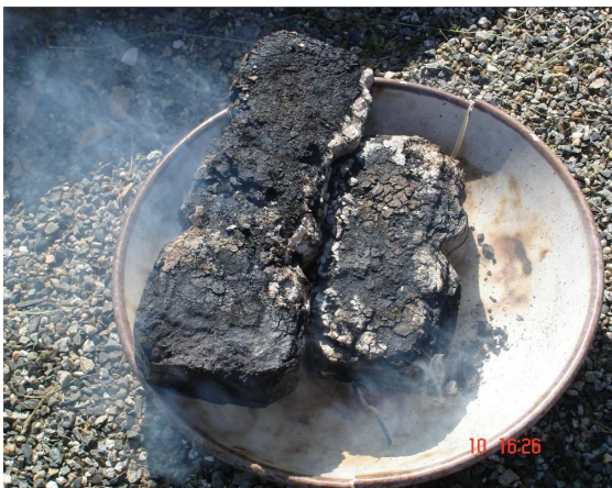
Figure 1.14 – Résidus de lignite (gauche) et de tourbe irlandaise (droite) après passage en chambre de combustion durant la campagne de Lannemezan (mai 2006)
