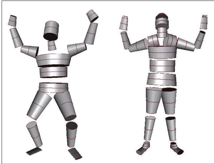
FIG. 4.6: Chacune des parties du corps humain est modélisée par un ou plusieurs cônes elliptiques tronqués. Nous donnons ici la représentation simple et la représentation complète du modèle  $3D$  utilisé pour effectuer le suivi du mouvement. Sur le modèle complet, nous avons rajouté les épaules, le bout des doigts, les chevilles et le sommet du crâne.
