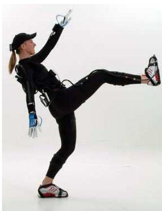
FIG. 2.2: Système de capture du mouvement FastTrack.
