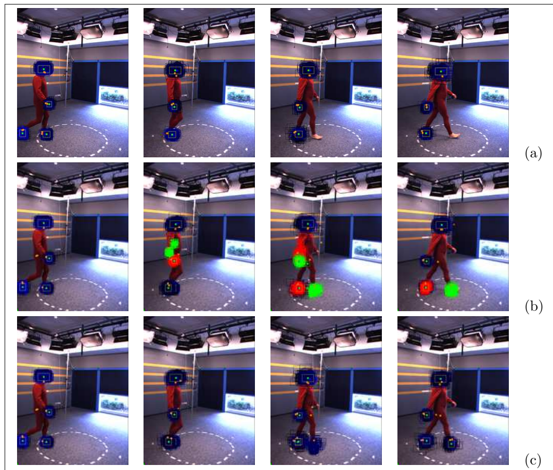
FIG. 8.5: Nous illustrons ici le suivi à l'aide du filtrage particulaire pour différentes étapes de l'algorithme. La première ligne montre l'échec du filtrage lors de l'approche naïve ne prenant pas en compte le ré-échantillonnage multi-modal. La seconde ligne présente le suivi lorsque nous utilisons le ré-échantillonnage multi-modal. Les blobs verts et rouges sont une représentation des modes de chacun des filtres. Les blobs bleus ne sont pas multimodaux. Enfin, la dernière ligne représente le filtrage lorsque la prise de décisions de refus des modes est mise en place.
