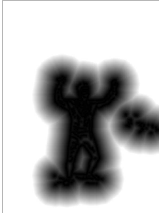
FIG. 5.27: Somme de la transformée en distance de la carte des contours et des silhouettes.
