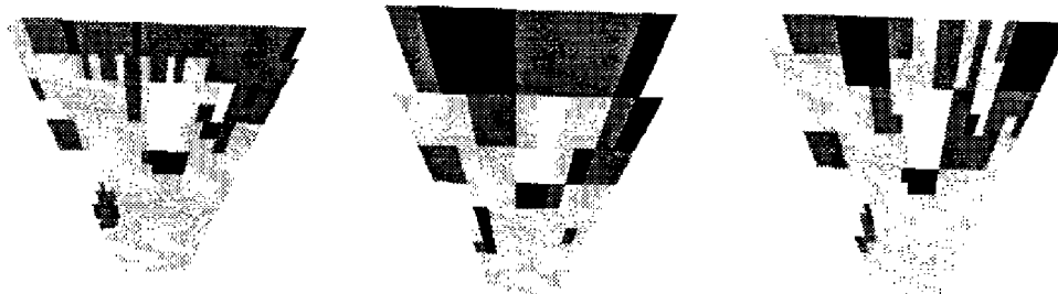
Figure 3.25 : Classification d'une image à trois résolutions différentes (de gauche à droite, résolution 512^2 , 256^2 et 128^2 - les classes sont représentées en niveaux de gris : noir = obstacle, gris foncé = accidenté et gris clair = plan)
