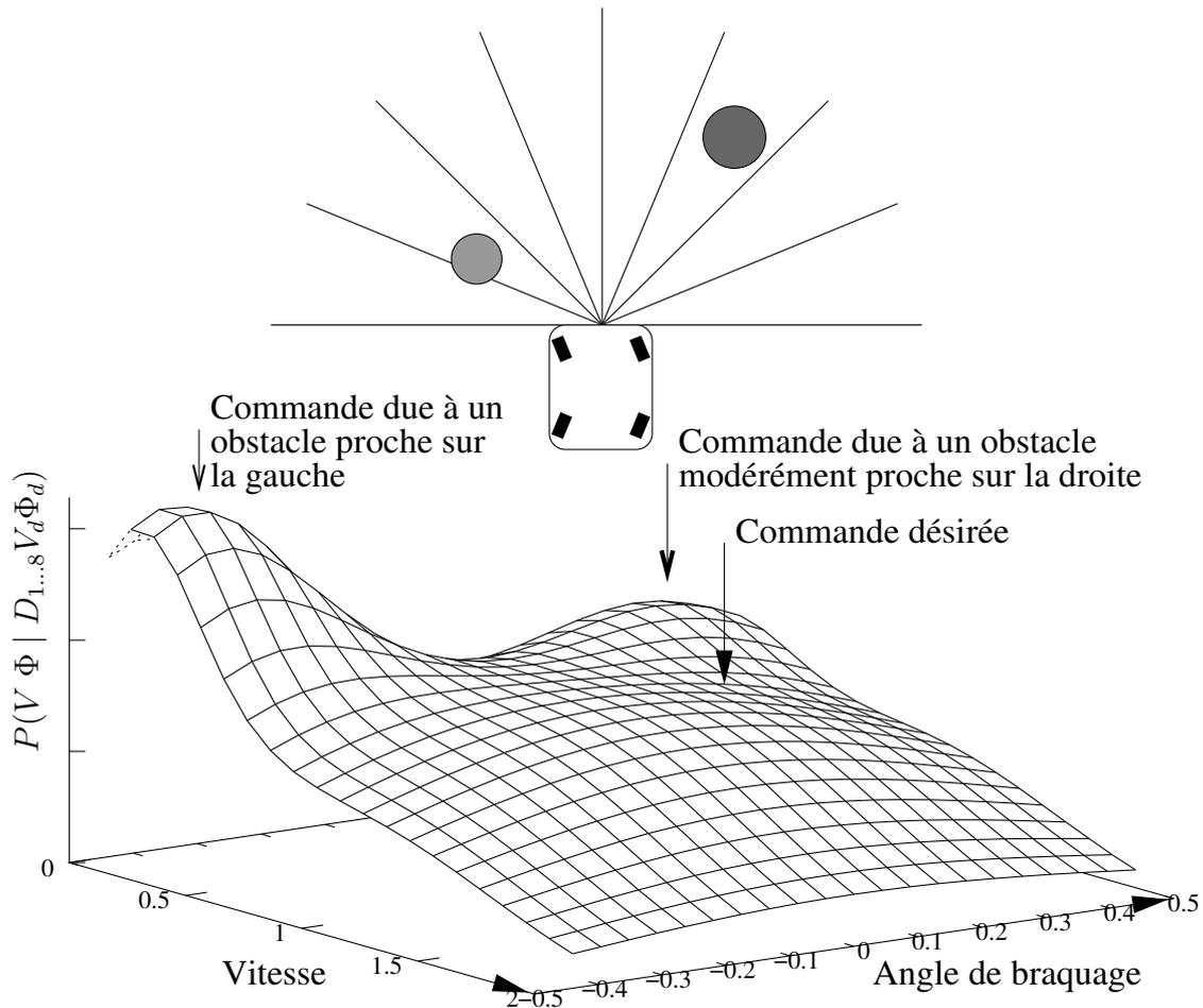
FIG. 6.9: Distribution de probabilité sur la vitesse et l'angle de braquage, résultant du processus d'évitement d'obstacles.
