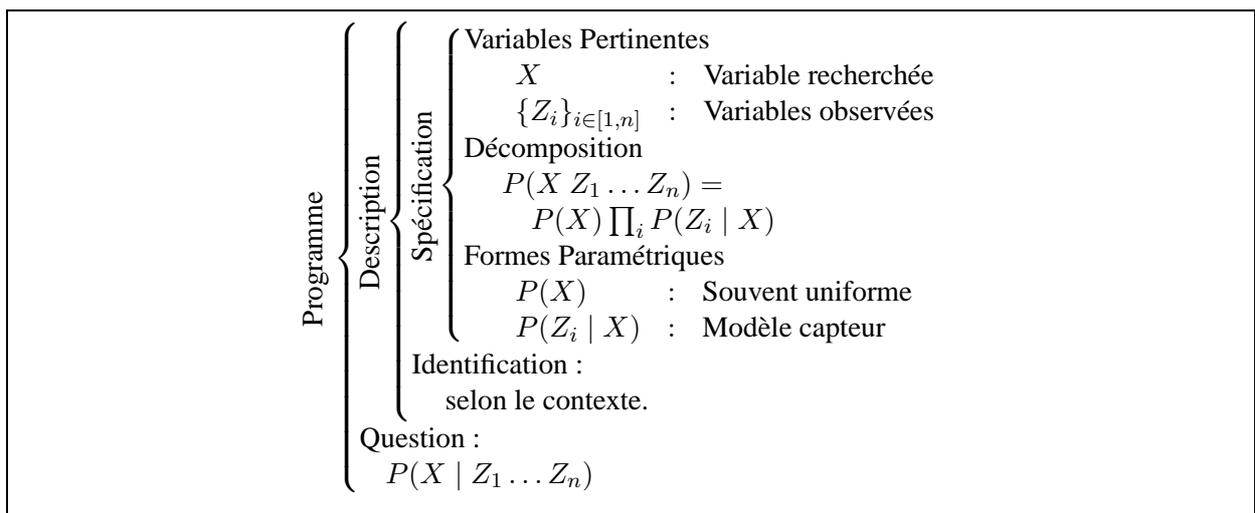
FIG. 2.5: Modèle de fusion de données bayésienne
