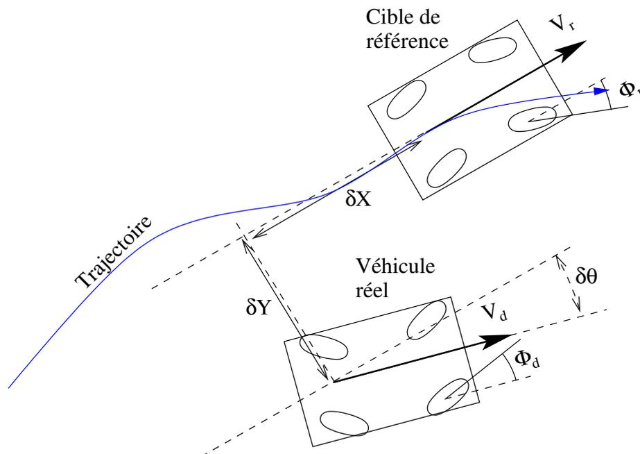
FIG. 6.2: Variables utilisées dans le suivi de trajectoire.
