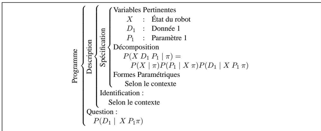
FIG. 7.3: Système exemple : programme bayésien du capteur 1
