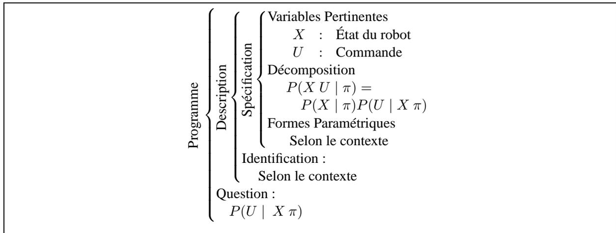
FIG. 7.2: Système exemple : programme bayésien de contrôle
