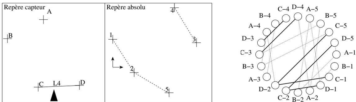
FIG. 4.8: Graphe de correspondances, identification du segment L4.
