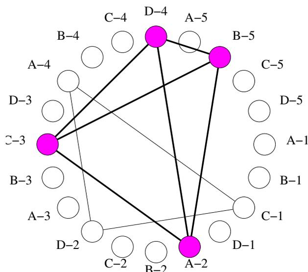
FIG. 4.18: Mise en correspondance par graphe de correspondances, en utilisant les triangles formés par trois amers : clique finale et résultat.
