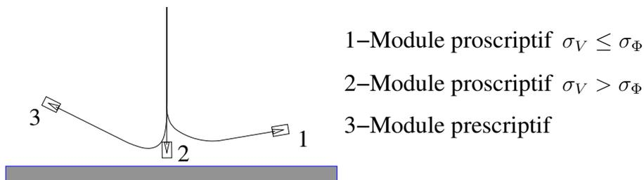
FIG. 6.18: Comparaison des trajectoires d'évitement d'obstacles.
