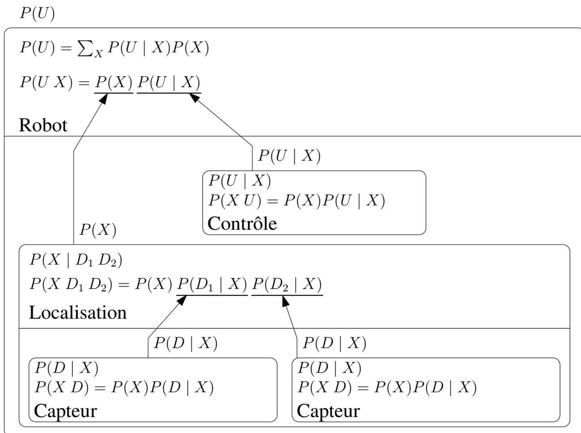
FIG. 7.6: Architecture de contrôle définie en PBOO.
