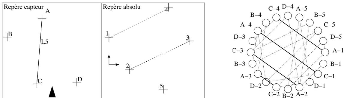
FIG. 4.9: Graphe de correspondances, identification du segment L5.
