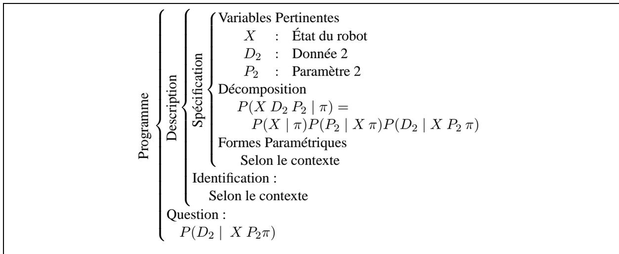
FIG. 7.4: Système exemple : programme bayésien du capteur 2
