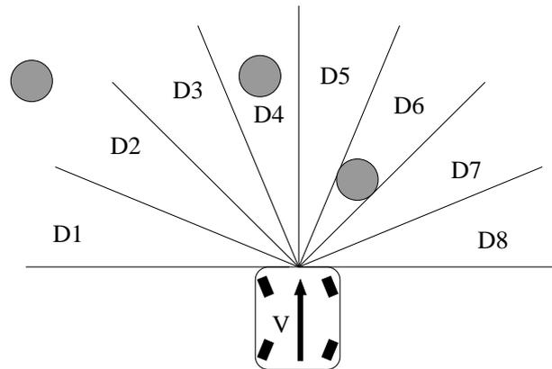
FIG. 6.13: Résultats de l'évitement d'obstacles : situation expérimentale.
