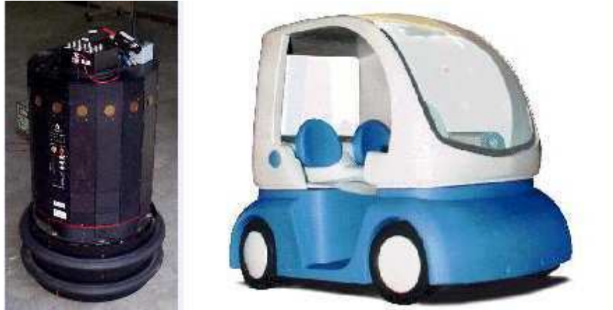
FIG. 1.1 – Types de robots étudiés Le robot Nomad 200 (à gauche) est un robot expérimental holonome de base cylindrique, de type robot de service. Le robot Cycab de l'INRIA (à droite) est un véhicule expérimental non-holonome, de base rectangulaire, de type système de transport automatisé. Ils sont représentatifs de la plupart des robots à roues existants, et des types de robots que nous serons amenés à considérer dans ce document.
