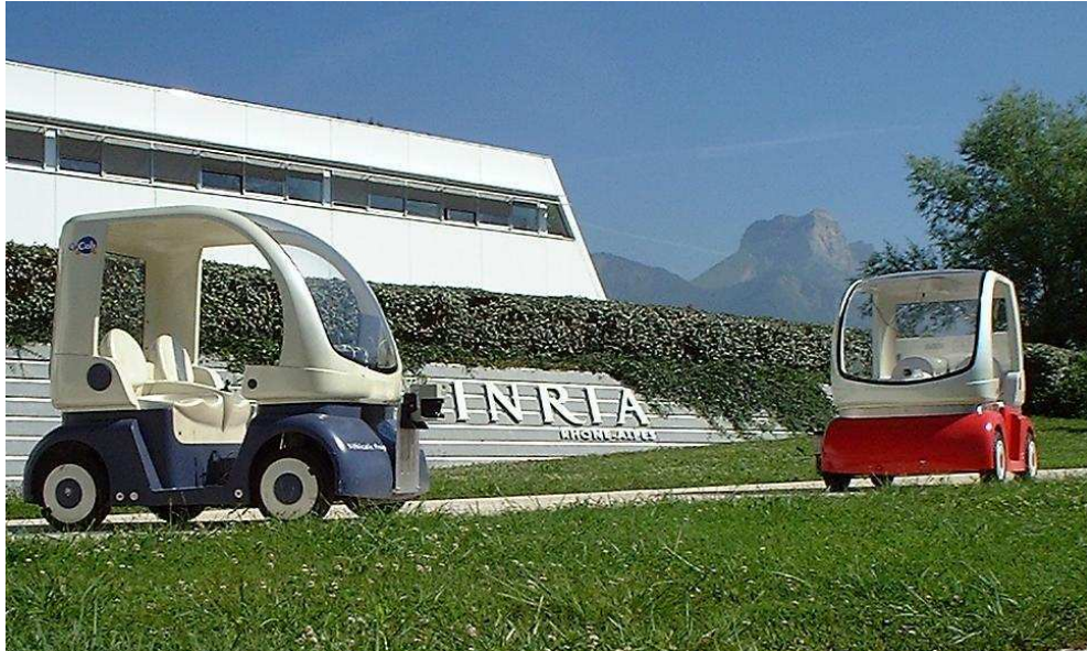
FIG. 4.24 – Cycab de l'INRIA Rhône-Alpes . Le Cycab est un véhicule électrique équipé de capteurs divers en vue d'expérimentations robotiques. Il est présenté à l'annexe C.
