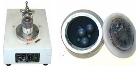
Figure 1-3 : Pulvérisette et son bol en agate
