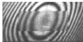
FIG. 4.11 – Interférogramme obtenu par interférométrie de Fizeau pour mesurer la planéité de la face supérieure du réseau de période 210 nm de la configuration 300/210 nm.
