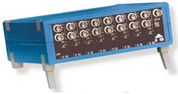
FIG. 4.2 – Photo du conditionneur. Assez imposant, il devra nécessairement être embarqué sur le robot.
