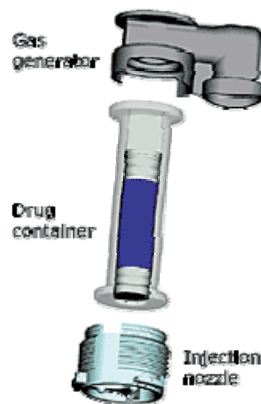
Figure 20. Schéma de la seringue sans aiguille à générateur de gaz pyrotechnique industrialisée par cross site technology
