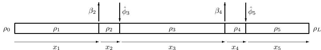
Figure 7: Section d'autoroute avec entrées et sorties.
