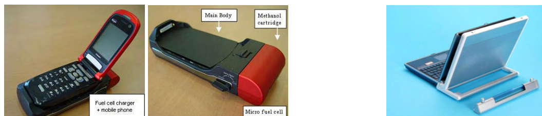
NTT DoCoMo (pour 2006), Spécifications : taille : 152 \times 57 \times 16 \text{ mm} , poids : 190 \text{ g} , Méthanol : 18 \text{ cc} , 30\% , sortie : 5,4 \text{ V} , 700 \text{ mA} , 50 \text{ mW/cm}^2 .
