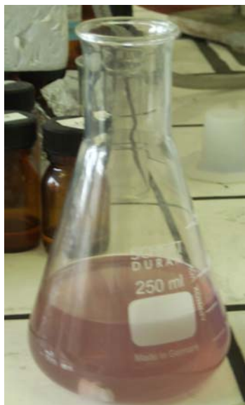
Figure 12: Solution d'or dans du chloroforme avant la roto évaporation
