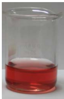
Figure 10 : Solution aqueuse de nanoparticules d'or de petite taille, 3 à 5 nm environ
