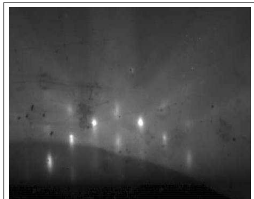
FIG. 7.2: Cliché RHEED d'une surface de GaAs juste après désorption de la couche d'arsenic « amorphe » dégradée. L'azimut associé est [110].
