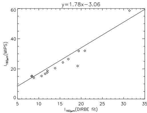
**FIG. 6.6:** Comparaison des valeurs à  $160 \mu\text{m}$  calculées à partir des flux DIRBE aux flux MIPS observés à  $160 \mu\text{m}$ . La corrélation est ajustée par une droite de pente 1.78 et un offset de -3.06 qui vont servir à recalibrer les données.
