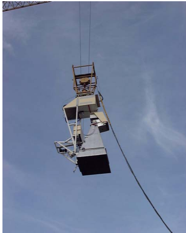
FIG. 3.3 – Photographie du radiomètre EMIRAD supporté par la structure développée à l'INRA
